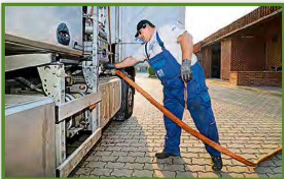
Jens Witschel und Michael Degen lassen etwa drei Kubikmeter Brauchwasser in eine Kammer des 12.000 Liter fassenden Spezialtanks auf dem Saugspülfahrzeug laufen: „Damit reinigen wir das Pumpwerk. Und in die zweite Kammer wird das Schmutzwasser aus der Anlage gesaugt.“
