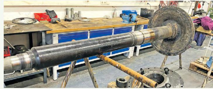
Der 3 m lange und 1 t schwere Faulschlammischer „ausgezogen“: Lager, Dichtungen und andere Teile sind demontiert, das Gerät wurde vom größten Schmutz befreit.
