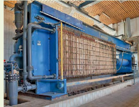
Der Zahn der Zeit musste lange nagen, bis die Kammerfilterpresse ersetzt wurde ...
