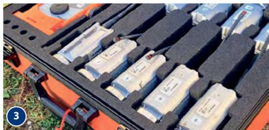
**Korrelatoren (1) messen und analysieren Geräusche oder Druckwellen, die Lecks in Rohren erzeugen. Sie ermitteln den genauen Ort der Bruchstelle aus der Zeitdifferenz, mit der das Geräusch an zwei Messpunkten ankommt.**
